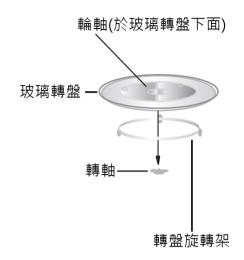
注意! 切勿把玻璃轉盤倒置安裝。玻璃轉盤安裝後須能輕鬆轉動。
